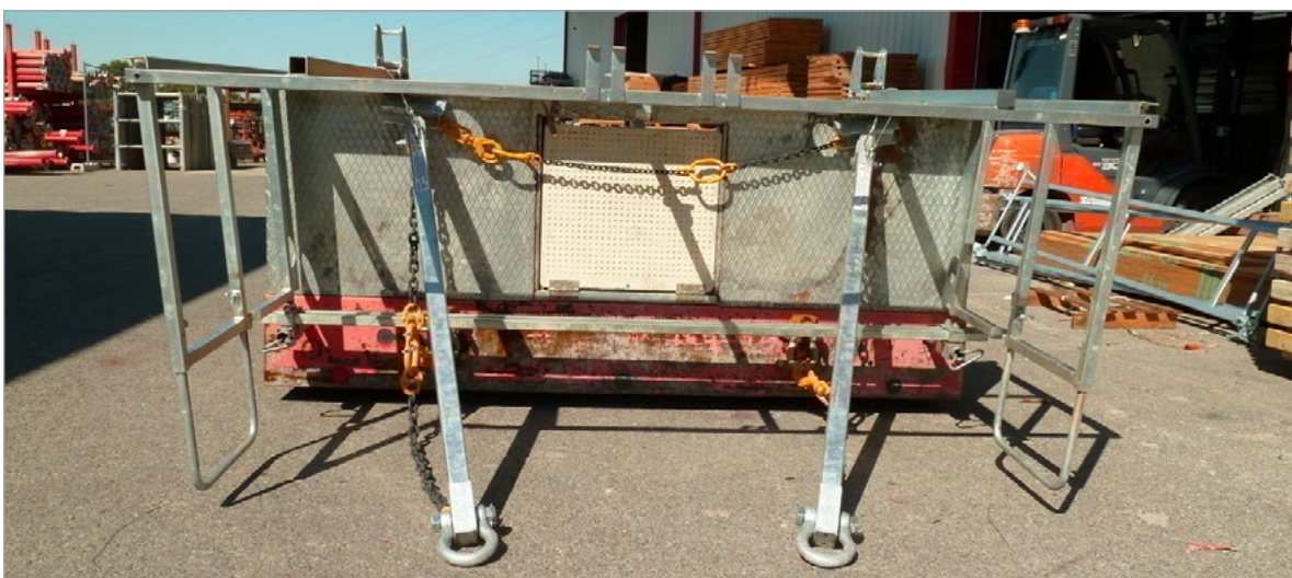
8 Représentation des béquilles correctement montées.
