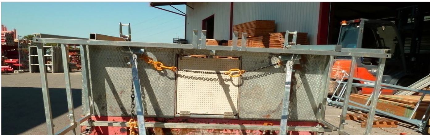
7 Montage de la chaîne centrale pour la banche de 2.40m
