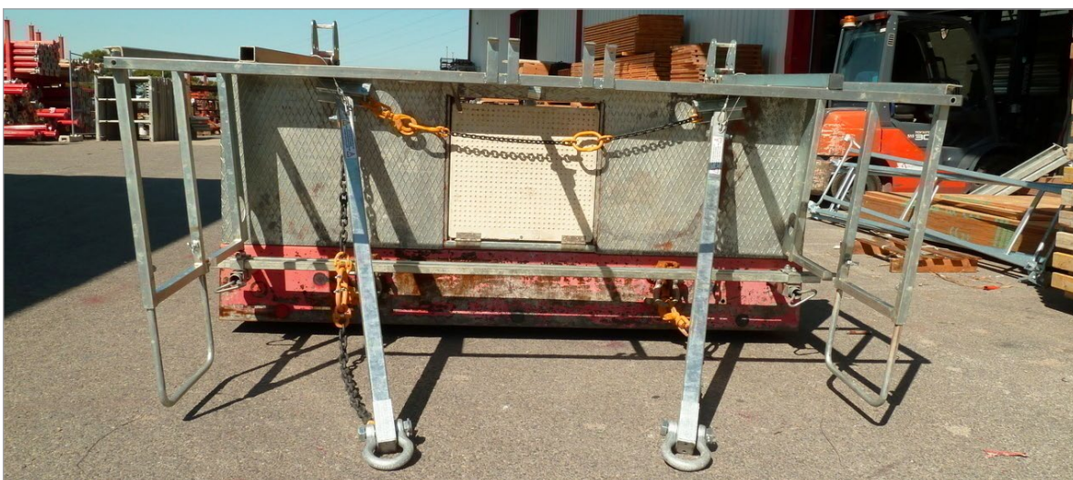
8 Représentation des béquilles correctement montées.
