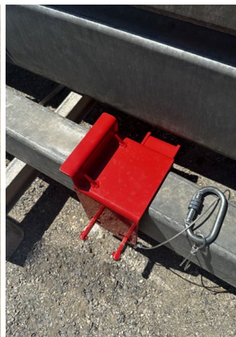
Attache de la bride via la fourche
