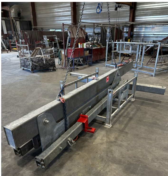
Palonnier replié pour le transport
