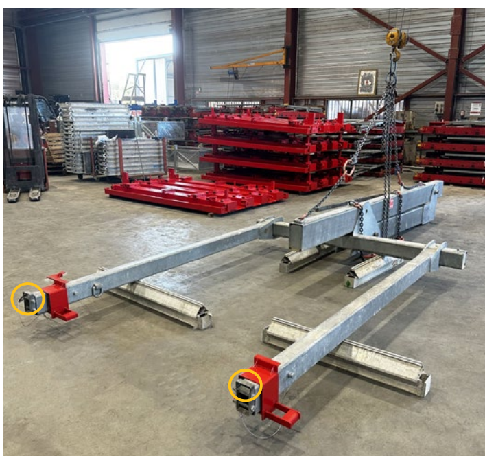
Palonnier replié pour le transport
