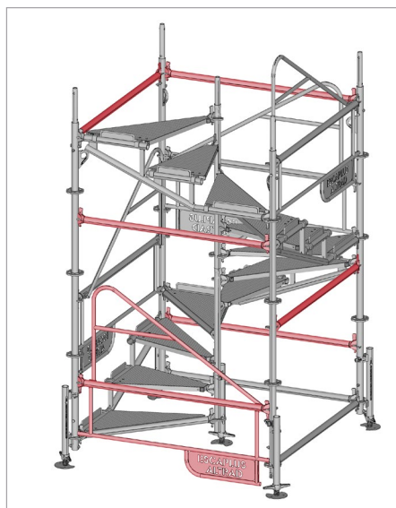
13 Installer une main courante niveau 0m, ainsi que les lisses de 1,5m.
