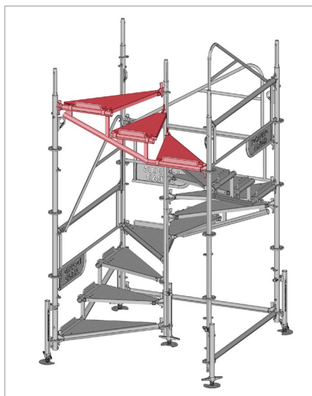
12 Installation du dernier limon et des trois dernières marches.
