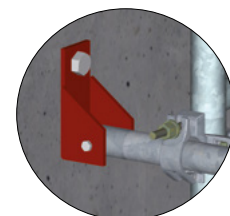
Stabilisation d'une tour 125 x 160 par ancrage
