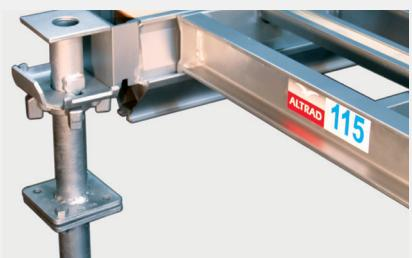
Les **poutrelles aluminium** reposent sur la partie mobile de la tête de coffrage par le biais de poutrelles primaires qui reçoivent les poutrelles secondaires ou les panneaux.
