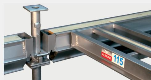
La partie mobile de la **tête de coffrage**, en s'abaissant après manœuvre du verrou circulaire, permet à l'ensemble des poutrelles et panneaux de descendre en position décoffrage tout en laissant la dalle étayé sur la tête.
