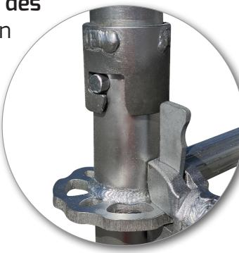
La tour ALTRALIGHT est mixte, composée d'aluminium et d'acier. Les cadres aluminium sont conçus en intégrant des composants de connexion et d'extrémité de poteau en acier lui conférant une robustesse à toute épreuve. Sa résistance aux chocs dues à la manutention sur chantier en sera inégalée. Elle reprend une charge de 5,5 tonnes par pied à 6,40m d'hauteur utile.
